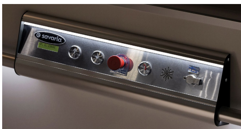
Ovládání se stálým stiskem, podsvícená tlačítka a palubní stavový displej
